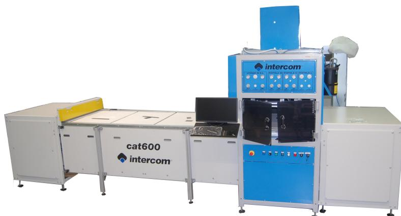
Movimentazione automatica dei pallet: nella configurazione sono inclusi un minimo di 16 pallet dalle dimensioni 850x615 mm. Questa configurazione permette all'operatore di avere sempre a sua disposizione 4 pallet in prima linea sui quali riporre il materiale per riprenderlo al momento dell'accoppiatura.
