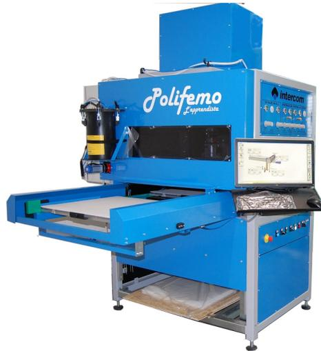
El desplazamiento es semiautomatico con 2 cajones (metiendo un cajon en la maquina, simultaneamente sale el segundo) Este modelo està equipado para una siguiente trasformacion en la version completamente automatica con elevador (DV.600).
